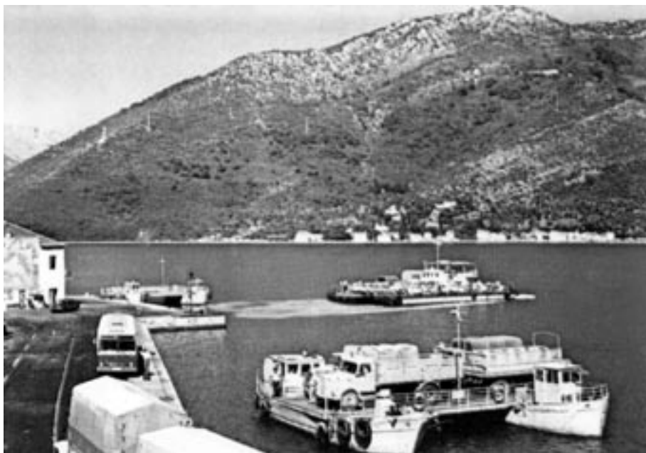
Trajekt sa platformom izrađenom u Brodogradilištu Bijela, montirane na leutima 1966. godine
